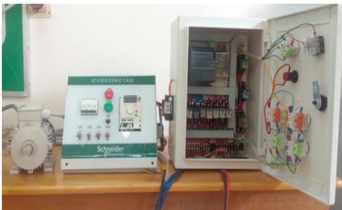
Hình 6. Mô hình điều khiển của hệ thống tưới và phun thuốc tự động.
