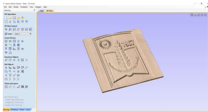
Hình 11. Mô hình 3D sau khi gia công bằng mô phỏng ảo.
