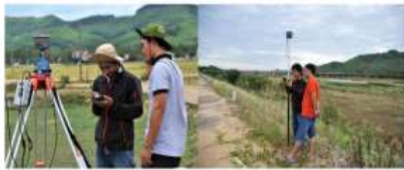
Hình 1. Đo mặt cắt ngang lòng sông Lại Giang tại vị trí Trạm thủy văn An Hòa năm 2018
