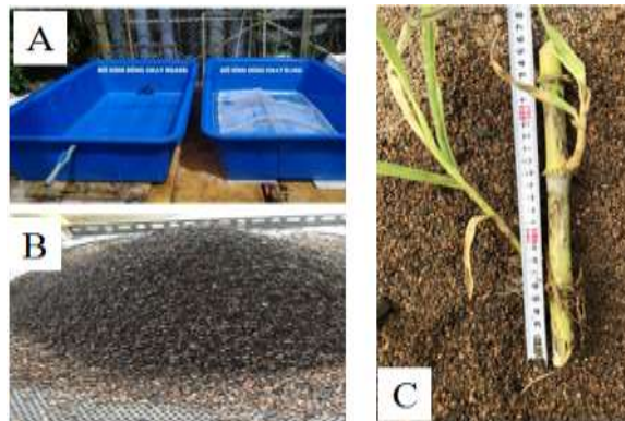
Hình 1. Vật liệu nghiên cứu: A) Bể nhựa sử dụng làm mô hình thí nghiệm; B) Xỉ than tổ ong sau khi rây sàng; C) Cỏ voi;
